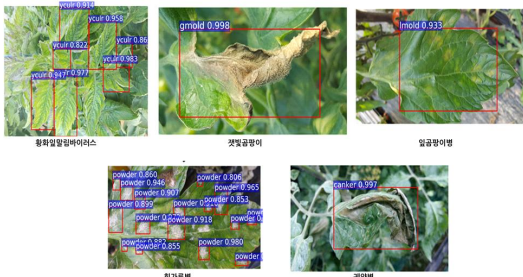
그림 14. 실증 데이터의 실험 결과 예시(궤양병과 황화잎말림바이러스는 기존의 학습 데이터 셋을 일부 사용) Fig. 14. Example of experimental results of empirical data (Canker and Yellow curl use some of the existing training data sets)
